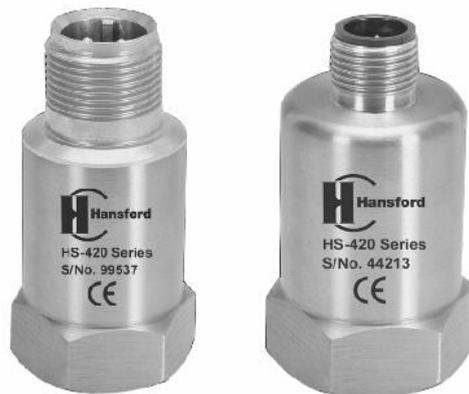
A Série **HS-421** de acelerômetros industriais são dispositivos piezoelétricos que oferecem DUAS saídas: uma 4-20 mA proporcional a velocidade e uma AC "g" para coletor de dados.
